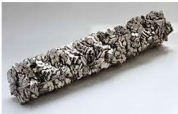
Figura 2.12. O bară de cristal de titan produsă prin reacție cu iodul [12]
